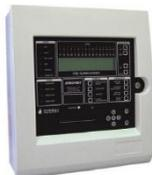
Central analógica endereçável 2 loop (Expansível a 3 Loops); 125 elementos por Loop; Modo Dia/Noite; 2 Bat. 12V 7Amp; Dimensões: 370x340x127mm.
