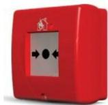
Botoneira rearmável de acção manual com LED de activação oculto; sistema convencional; Configurável para 2 modos: intrusão (contacto-directo) ou incêndio (loop de corrente). **Montagem Superfície**; Dimensões: 100x100x49mm.
