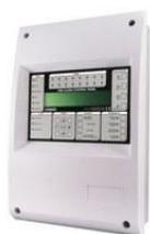
Central analógica endereçável 1 loop (Expansível a 2 Loops); 125 elementos por Loop; Modo Dia/Noite; 2 Bat. 12V 7Amp; Dimensões: 272x404x107mm.
