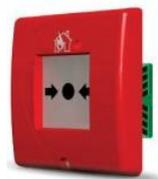
Botoneira rearmável de acção manual com LED de activação oculto; sistemas convencional; Configurável para 2 modos: intrusão (contacto-directo) ou incêndio (loop de corrente). **Montagem Embutir**; Dimensões: 100x100x30mm.
