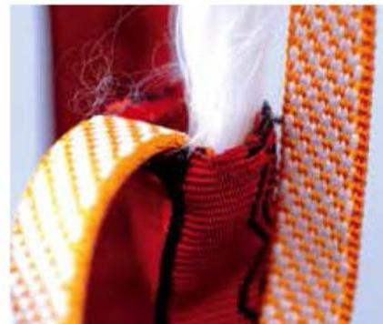
Os absorvedores da série Shockyard da Skylotec estão patenteados (não têm bolsa de absorção que golpeie ou incomode). Mais leves e fáceis de usar. Tira interna de Dyneema de protecção em caso de ruptura. Travagem progressiva da queda e sem sobressaltos, uma vez que as fibras de poliéster se vão abrindo pouco a pouco, amortizando fisicamente a queda. Este efeito é também psicológico, já que reduz o impacto emocional da queda.
