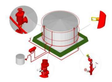
Os sistemas de extinção de incêndios por espuma são normalmente utilizados no combate a fogos de combustíveis líquidos.
