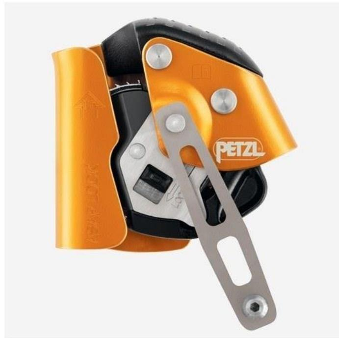
Asap Lock integra uma função bloqueador, que permite ao utilizador imobilizar o aparelho para reduzir a altura da queda.
