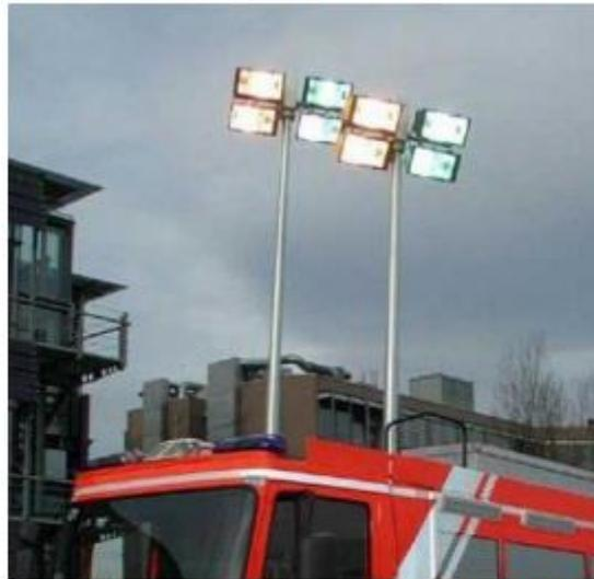
Os mastros leves são excelentes mastros de iluminação e de telecomunicações para suportar equipamentos de medição. Eles podem ser acionados manualmente ou com uma bomba de mão. Todas as seções podem ser bloqueadas. Eles estão preparados para montagem em veículos, em um tripé ou uma tomada.
