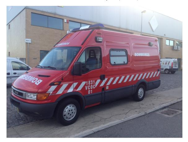
Veículo concebido para a montagem de Postos de Comando Operacional com uma área de Transmissões e uma área de Comando, perfeitamente delimitadas;
