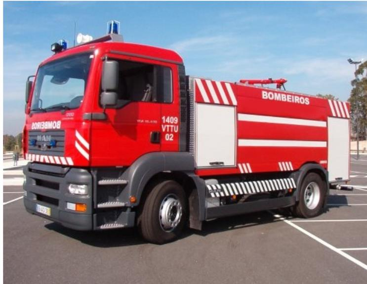
Veículo de apoio do tipo 4 x 2, de categoria S1, equipado com bomba de serviço de incêndios destinado ao abastecimento de veículos de combate a incêndios e outras actividades de apoio, de acordo com a Norma Europeia 1846 – 1,2, 3.
