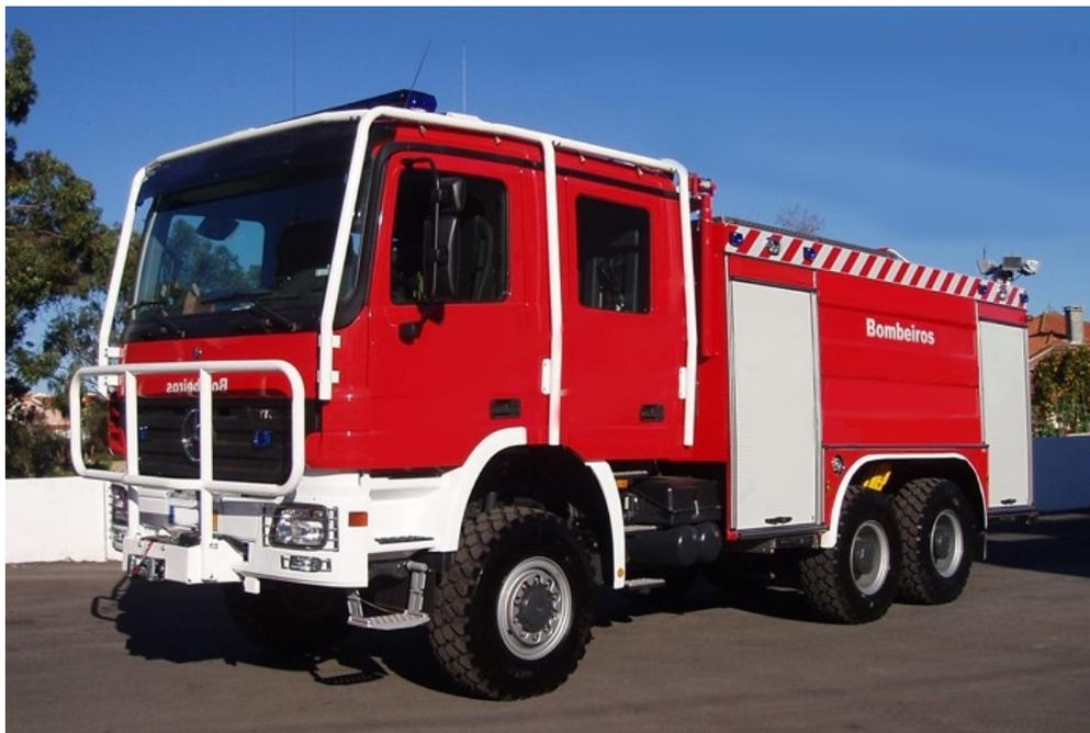
É um veículo de combate a incêndios que utiliza meios especiais de extinção, com ou sem agentes extintores, normalmente com capacidade superior a 4000 litros.
