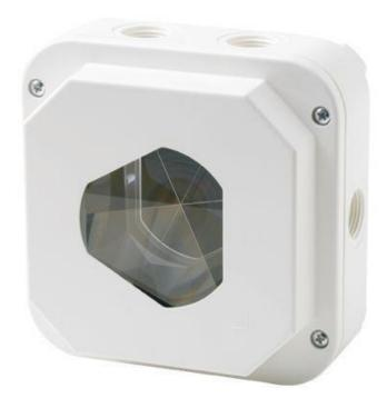
Os reflectores são caracterizados pelo facto de que um raio de luz que colide é reflectido em paralelo. O reflector não necessita de ser montado a um ângulo recto com o raio de luz. Vibrações e distorções na parede onde o refletor é montado não causam distúrbios também. Outra vantagem reside no facto de que a luz eventualmente interferentes reflecte-se também sobre si próprio e não pode, assim, atingir o receptor.
